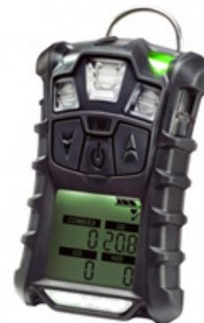
Explosímetro (Detector de gases)
