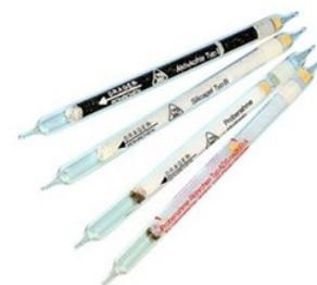
Pueden mencionarse también los dispositivos de lectura directa que son aquellos en los que la toma de muestra y la determinación de la concentración es simultánea, siendo por lo tanto rápida, ya que no requieren tratamiento analítico. Ej. tubos colorimétricos, etc.
