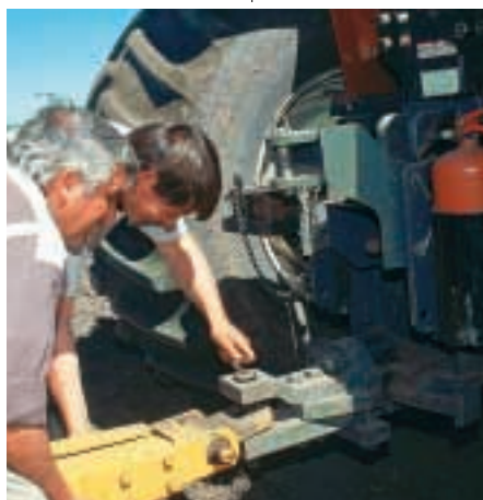
Al momento de realizar el enganche de los equipos al tractor (arriba) se deben alejar las manos del punto de acople. Las tomas de fuerza (abajo) tienen que contar con un escudo protector. Los escapes de los tractores (derecha) no deben dificultar la visibilidad del conductor.
