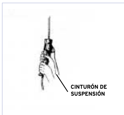
Ejemplos de dispositivos para operaciones de descenso: evacuadores o descendedores
